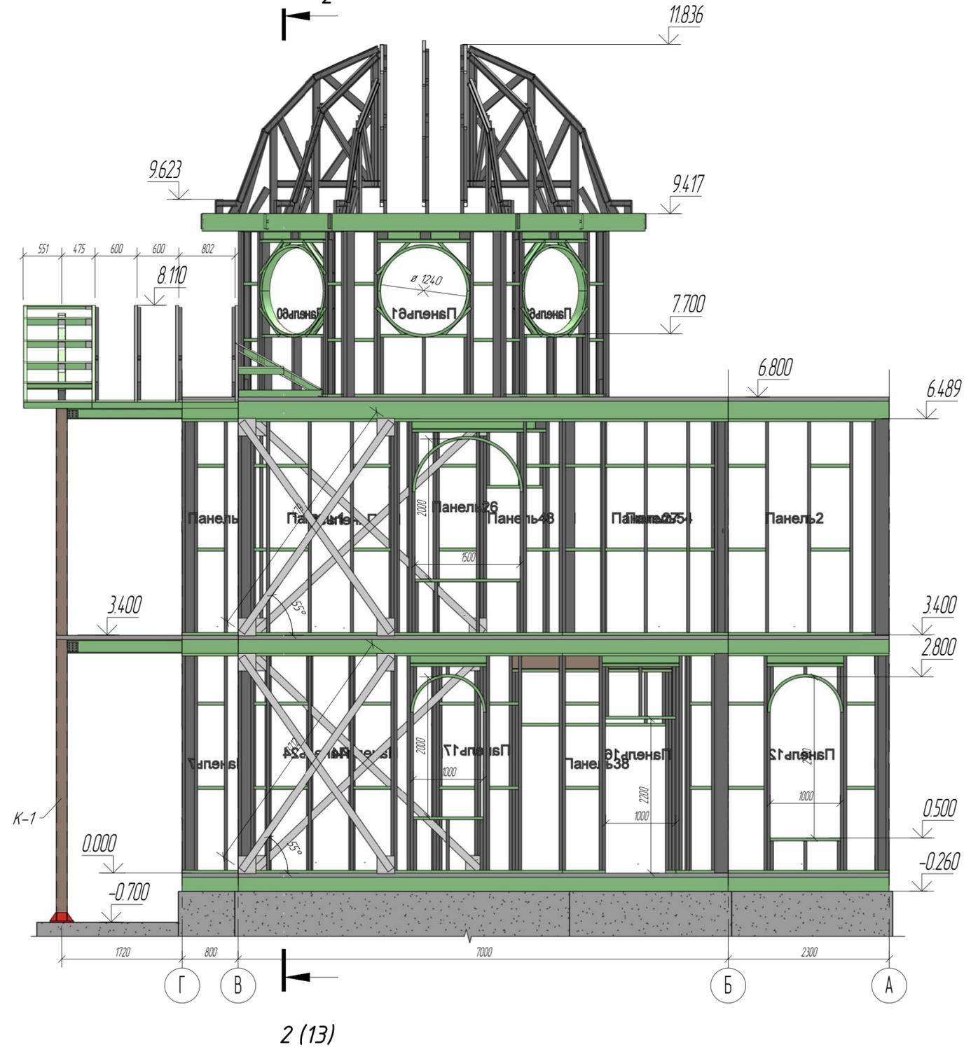
1. Крепить горизонтальную полосу 80x12 в местах установки блоков стеновых панелей с обеих сторон саморезами 4,8x19 по 2 шт в каждом пересечении.
