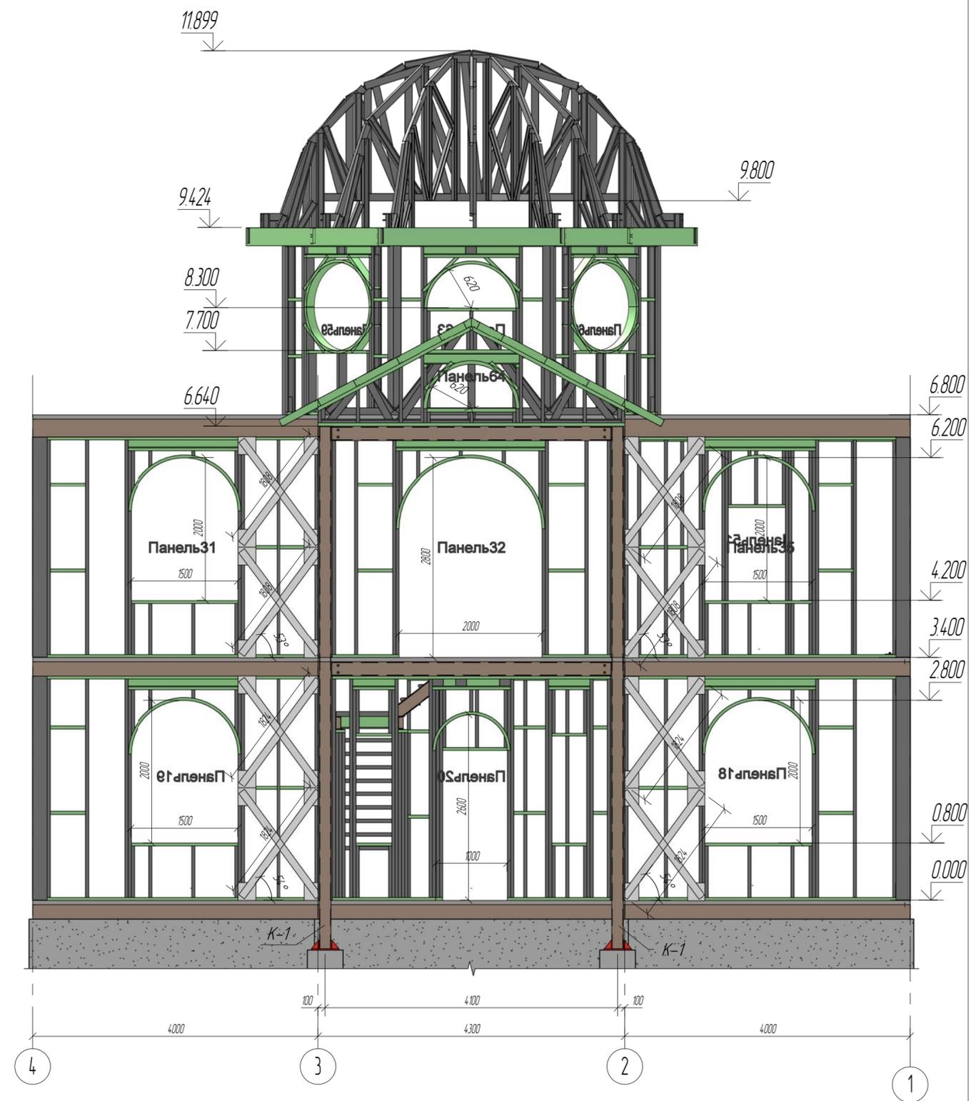
1. Крепить горизонтальную полосу 80x12 в местах установки блоков стеновых панелей с обеих сторон саморезами 4,8x19 по 2 шт в каждом пересечении.
