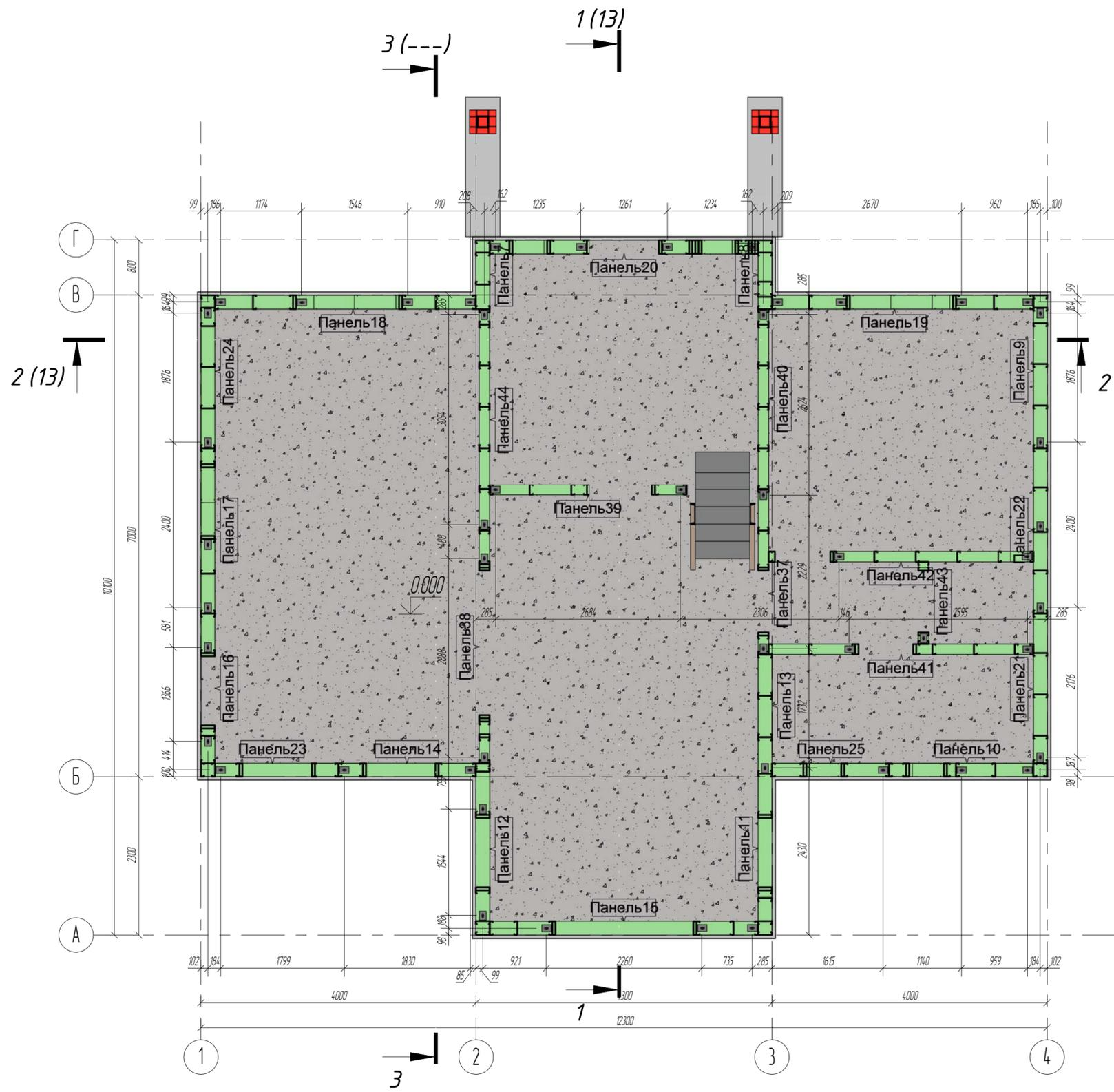
1. Дополнительно крепить несущие стеновые панели вбиваемым анкером с шагом 1200 мм.
