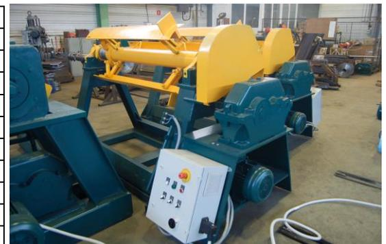
Размотчик оборудован системой управления (CAU), позволяющей работать в двух режимах – ручном и автоматическом. Скорость вращения катушки зависит от величины провиса полосы, контролируруемую бесконтактными датчиками.
