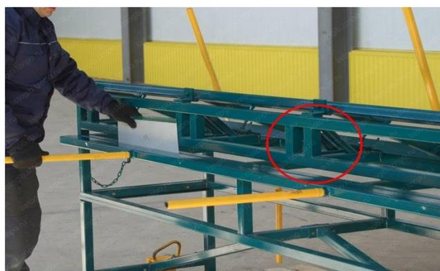
Теперь прижим осуществляется жестко и равномерно по всей длине, а станок позволяет зажимать узкую заготовку без выдавливания ее из под прижимной балки в момент гибки.
