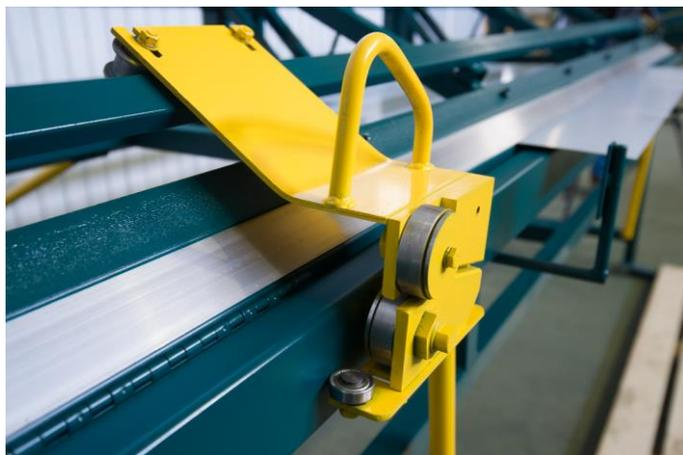
При правильно настроенной отрезной машинке расчётное усилие резания для стали марки 10кп для листа толщиной 0,5 мм составляет 25 кг.
