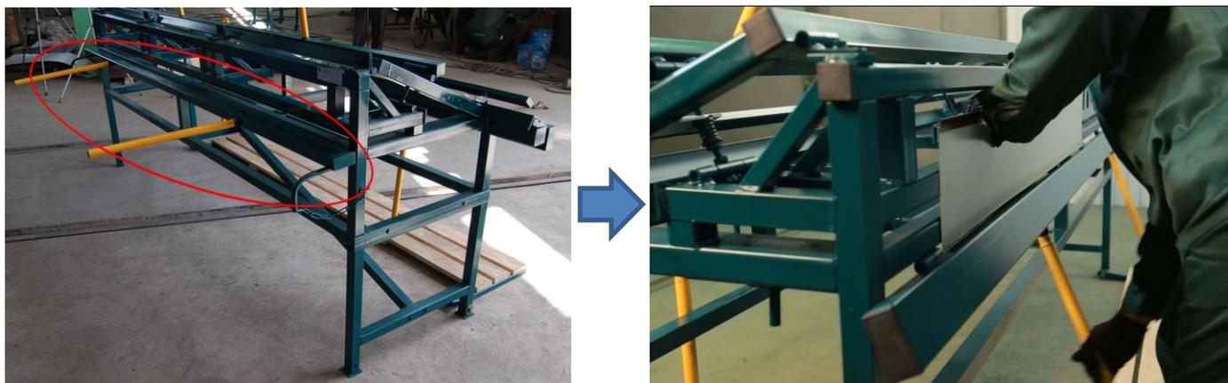
Убран ограничитель угла (многие его демонтируют сразу, т.к. он мешается), и добавлен угломер. В партии одинаковых деталей по очереди изготавливается каждая деталь – обычно, углы разные, поэтому всегда удобнее пользоваться угломером.
