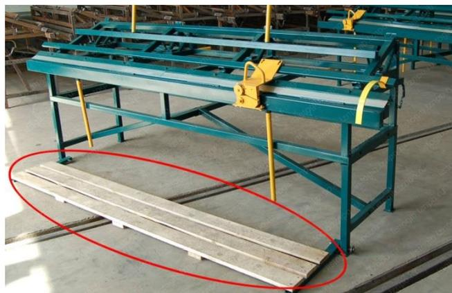
Алюминиевая направляющая для отрезной машинки заменена на стальную. Теперь ролики отрезной машинки не “накатывают колею” и не “зарываются” в алюминий:
