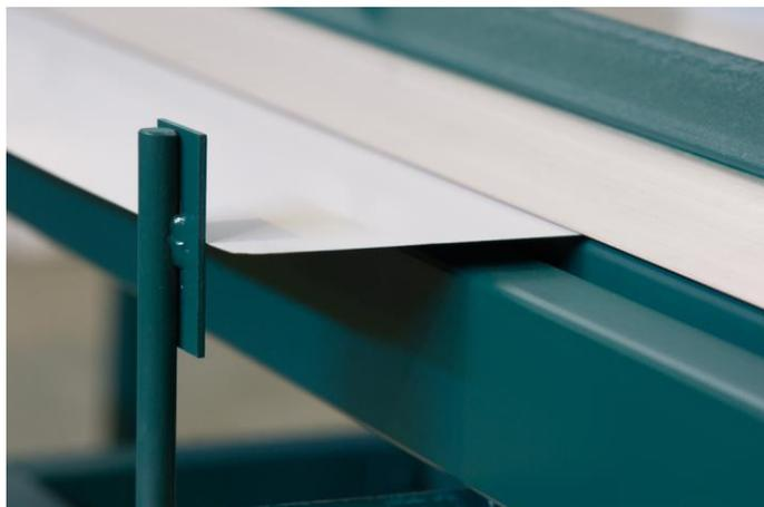
Заготовки для одинаковых деталей имеют одну ширину – на нее настраиваются упоры и остается только резать и подавать лист до упоров.
