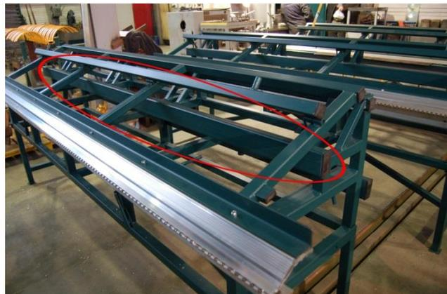
Усилены опорные узлы (сделано 8 узлов), уменьшено число опор прижимной траверсы до 4-х (т.к. с 5-ю опорами невозможно добиться равномерности прижима на длине 2,5м):
